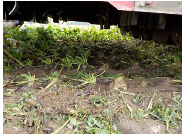
Foto 1: Ontbladeren met poetseras. Links de eerste klepelas met stalen en rubberen klepels. Het loof wordt hiermee verwijderd tot enkele korte loofprijken. Rechts de poetseras met rubberen klepels die het laatste loof van de biet afpoetst, waarbij de kop van de biet intact blijft.
