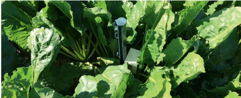
Figuur 35 De luchtvochtigheid en temperatuur in het bietengewas zijn bepalend voor de infectie-omstandigheden van de bladschimmels. De sensoren monitoren de omstandigheden en vertalen deze naar infectiewaarden.
