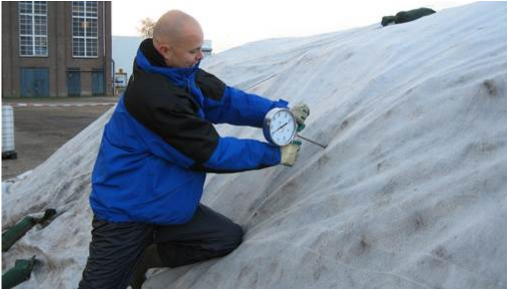
Figuur 8.4.7 Gebruik van een steekthermometer om de temperatuur in de hoop te controleren.
