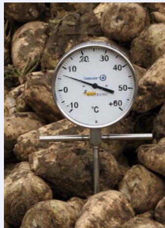
Controleer regelmatig de temperatuur in de hoop met een steekthermometer.
