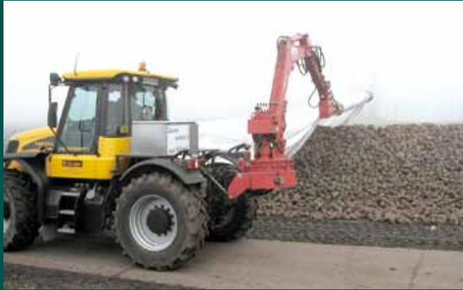
Mechanisch afdekken van een dakvormige hoop met vliesdoek (Toptex).
