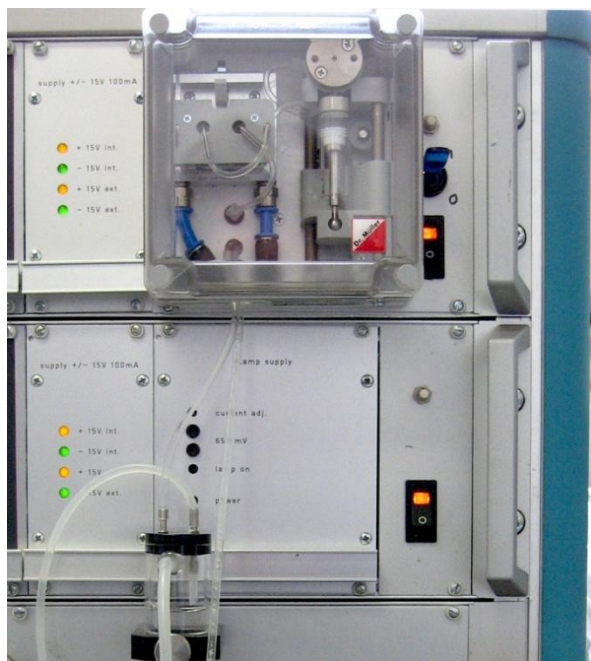
Figuur 1. Glucosemeter met linksonder het mengvatje waar het filtraat wordt gemengd met de buffer en midden boven de meetcel.
